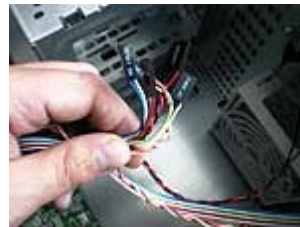
Connecteurs du boîtier (speaker, led, power, etc...)
